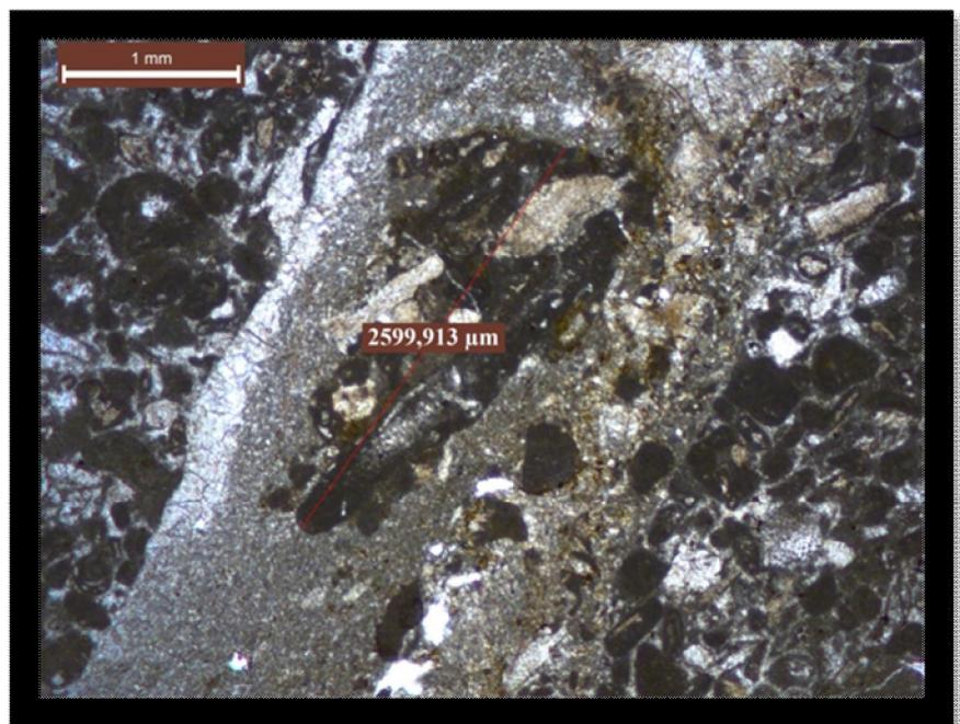
**Figura 2:** Detalle de la lámina en una zona de fractura recristalizada por calcita esparítico en la que observamos el tipo touching-vug pores (microfracturas conectadas por poros móldicos)
